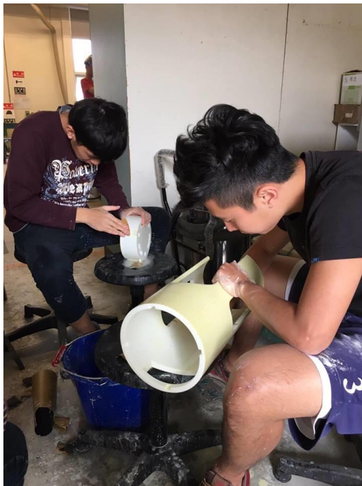
外觀初步打磨，上汽車補土，作第二層表面 處理砂紙係數 320 打磨到 600 （2017/02/06-14）
